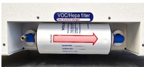
Obrázek 12.3 Správně nainstalovaný filtr VOC/HEPA
