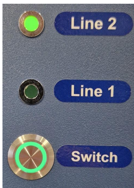
Obrázek 20.4 Spínač upravující vedení vícekomorového IVF inkubátoru MIRI® TL12 a aktivní linka 1
